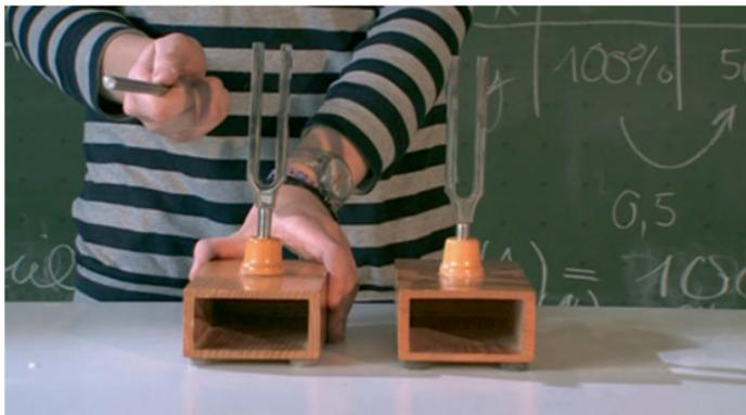
Abbildung 16: Resonanzkörper nimmt Schwingung auf
