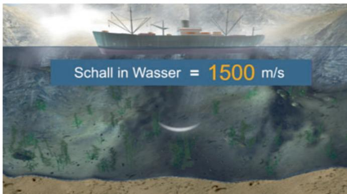
Abbildung 20: Funktion eines Echolots
