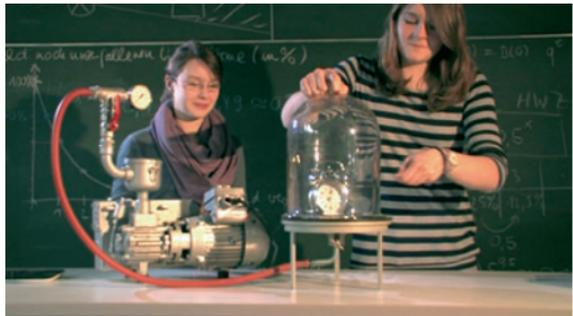
Abbildung 14: Kein Schall im Vakuum
