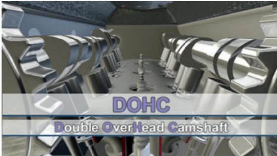
Steuerräder und Nockenwellen bei DOHC mit Ventiltassen.
