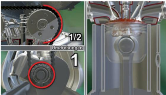
Abbildung 11: Steuerkette mit 2:1-Übersetzung
