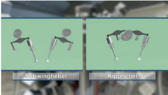
Abbildung 10: Andere Ventilsteuerungen
