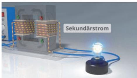
Hat die Primärspule mehr Wicklungen als die Sekundärspule, dann wird die Eingangsspannung heruntertransformiert. Hat die Primärspule hingegen weniger Wicklungen, so wird die Eingangsspannung hochtransformiert.
