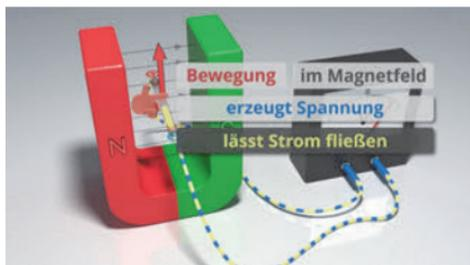
Im weiteren Verlauf zeigt der Film, wie verschieden konstruierte Generatoren entweder Gleichstrom oder Wechselstrom erzeugen. Dabei zeigt und betont der Film immer wieder, dass der Generator im Grunde eine direkte Umkehr des Elektromotors ist.
