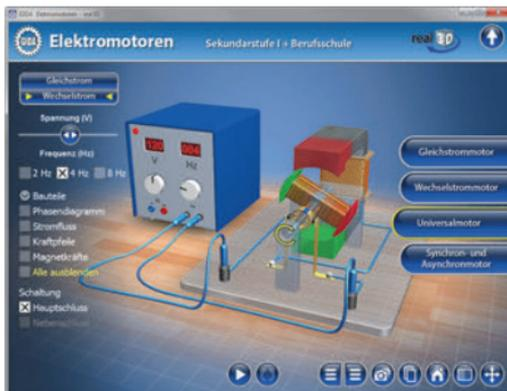
Nach Starten der Animation über den Play/Pause-Button erscheint ein Schieberegler für die Frequenz von 1 bis 50 Hertz. In der Animation wird deutlich, dass beim Universalmotor mit Wechselstrom die Spannung die Drehzahl des Motors bestimmt. Die Änderung der Frequenz bewirkt lediglich eine schnellere Umpolung des Eisenkerns.
