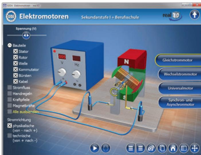
Die Spannung wird über den Schieberegler in der linken Menüleiste im Bereich von 0 bis 12 Volt verändert. Nach dem Starten der Animation kann man erkunden, dass sich über die Spannungsregelung die Motordrehzahl ändern lässt.
