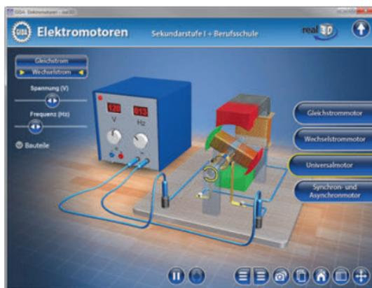
Über die linke Menüleiste können Phasendiagramm, Stromfluss, Kraftpfeile und Magnetkräfte zugeschaltet werden. Es wird die physikalische Stromrichtung zugrundegelegt. Der Universalmotor mit Wechselstrom wird im Modell nur im Hauptschluss betrieben. Er ist der Standardmotor für kleine Haushaltsgeräte.
