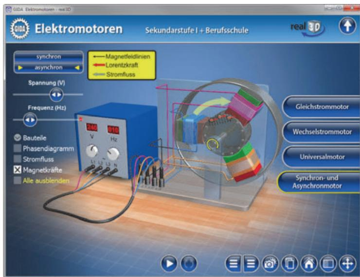
Aus Gründen der Übersichtlichkeit werden der vom Drehfeld induzierte Stromfluss und die resultierenden Magnet- und Lorentzkräfte nur in einigen Käfigstäbchen gezeigt. Es wird die technische Stromrichtung zugrundegelegt.
