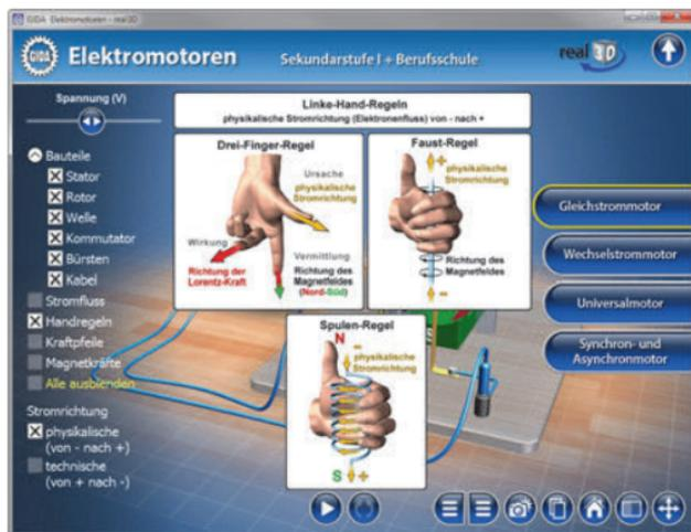
Die Stromrichtung lässt sich auf physikalisch (von – nach +) oder technisch (von + nach -) einstellen. Die Stromrichtung wird natürlich erst sichtbar, wenn gleichzeitig der Stromfluss angeklickt ist.
