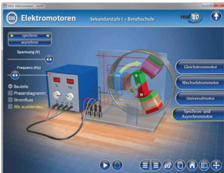
Im Teilbereich *asynchron* werden zwei Schieberegler angezeigt. Ein Schieberegler reguliert die Spannung von 0 bis 380 Volt, der andere die Frequenz von 0 bis 50 Hertz. Bei Erhöhung der Frequenz steigt die Drehzahl des Asynchronmotors. Eine Erhöhung der Spannung verstärkt die Magnetisierung der 3 Statoren und damit das Drehmoment des Motors.
