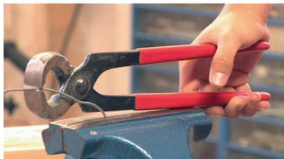
Abbildung 8: Zweiseitiger Hebel
